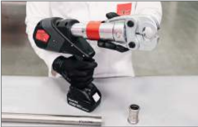
Preparazione della macchina pressatrice / Press machine preparation
